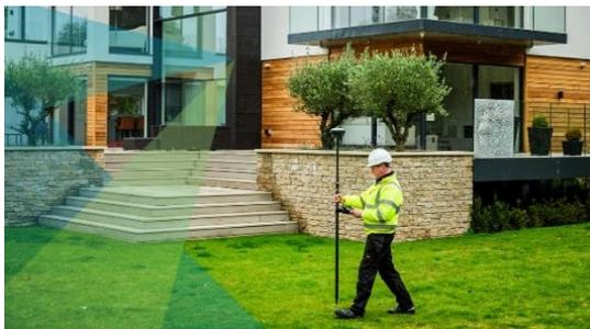
Der Leica GS18 I, ein vielseitiger GNSS-RTK-Rover mit visueller Positionierung für Vermessungszwecke. Konzipiert für Vermessungsprofis, die mühelos und genau Punkte messen möchten, die bisher mit einem GNSS-Rover nicht gemessen werden konnten. Jetzt haben Sie die Möglichkeit, Ihren Standort schnell in Bildern zu erfassen und davon ausgehend Punkte zu messen, entweder vor Ort oder später im Büro.
